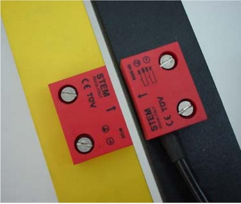
ejemplo de supervisión de resguardo extraíble con interruptores magnéticos de seguridad (codificados): dependiendo del módulo de seguridad el sistema cumple con la categoría de seguridad 1,3 o 4 según EN 954-1.
