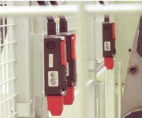
ejemplo de supervisión de resguardo extraíble con enclavamiento de seguridad y control de rotación: dependiendo del módulo de seguridad el sistema cumple con la categoría de seguridad 3 o 4 según EN 954-1 y se protege frente a inercias mecánicas.
