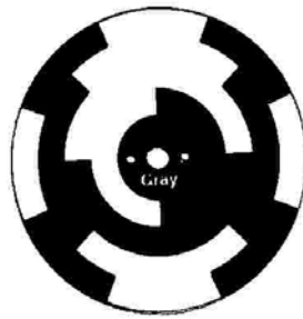
Figura 3. Codificador del eje de giro Gray CE300
