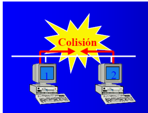
Figura 2: Efecto de la colisión en una red Ethernet
