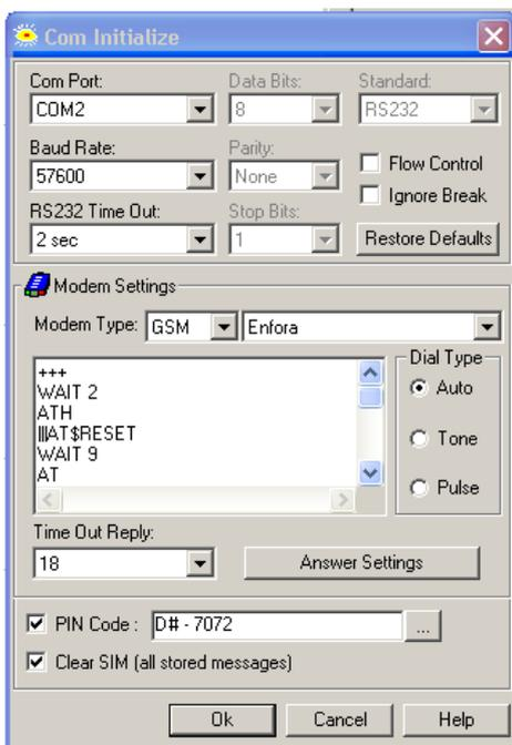
Donde Configuraremos en puerto del unitronics donde colocaremos el modem, seleccionaremos el modem y pondremos el pin de la tarjeta si tiene.
