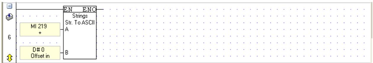
A continuación se coloca el siguiente segmento, en el cual pasa el valor numérico introducido por pantalla (teléfono) a ASCII para que lo entienda el PLC.
