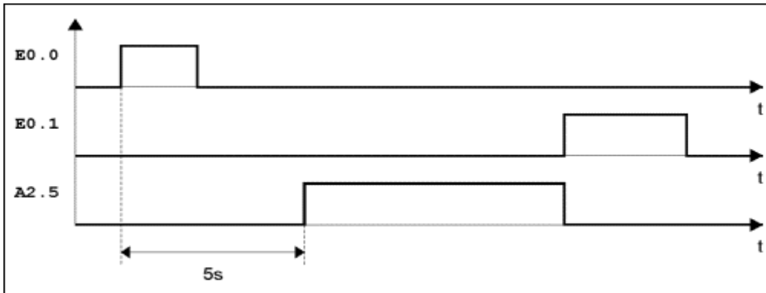
Diagrama de un temporizador con retardo a la activación con memoria y reset
