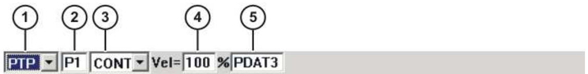
Fig.5-3-1-1: Formulario Inline para movimientos PTP
