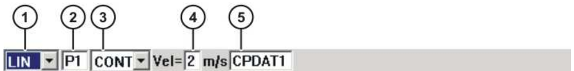
Fig.5-3-2-1: Formulario Inline para movimientos LIN
