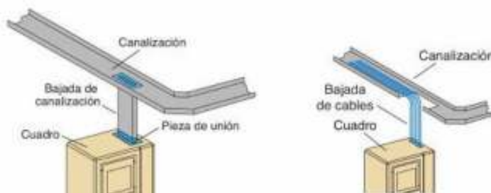
Fig.36. Fijación en bandeja y canaletas respectivamente.
