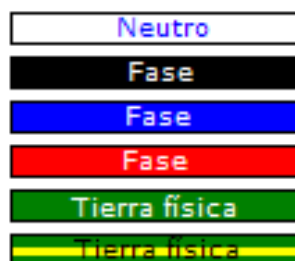
Fig.39. Código de colores en conductores
