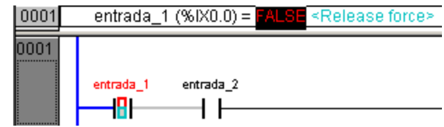
6 – Después de clikar otras 2 veces encima para quitar el forzado. Contacto con relleno mixto y variable <Release force> . No pasa la corriente. Si pulsa F7 se elimina el forzado y estamos
